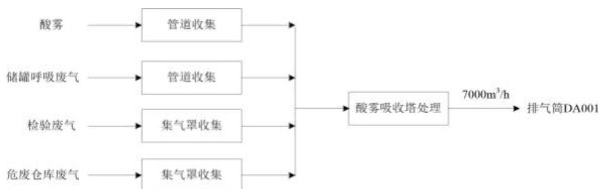
图 7.2-1 项目废气处理工艺流程图
